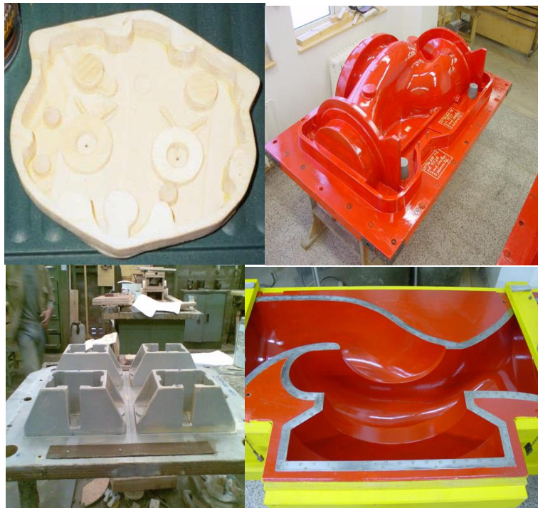
Gambar 4.12. Pola dari Kayu (kovatchcastings.com)
