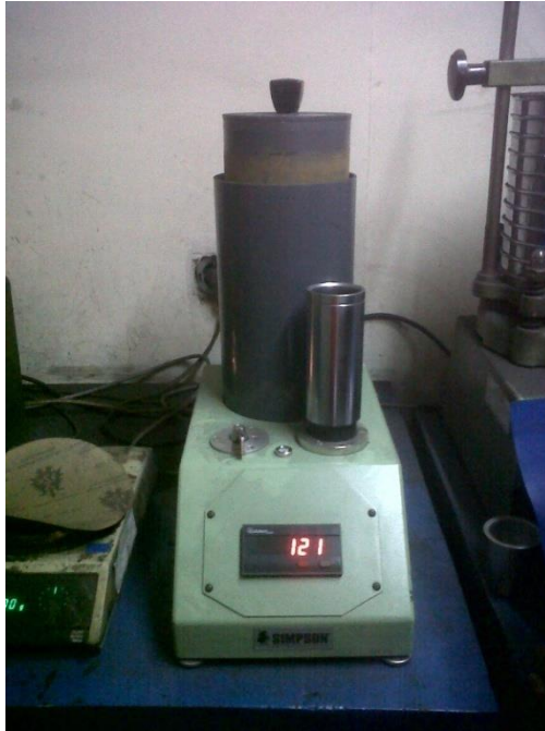
Gambar 3.3 Pengujian permeabilitas (Dokumentasi Penulis)
