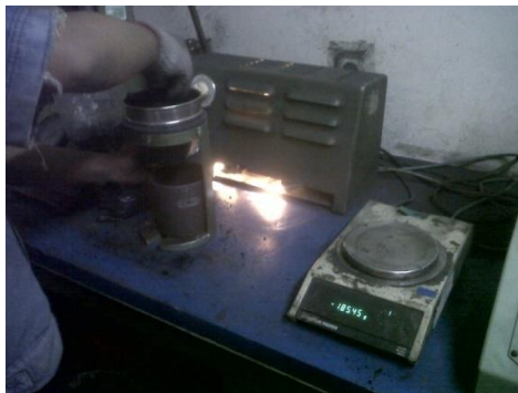
Gambar 3.2 Pengujian kadar air (Dokumentasi Penulis)
