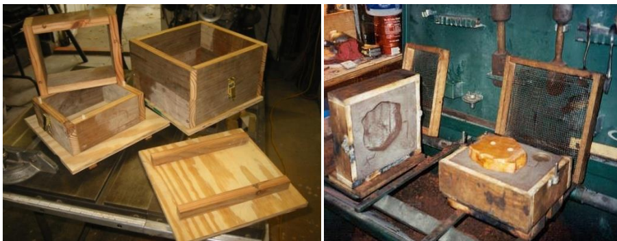
Gambar 2.6 Cope dan Drag dari kayu ( rpdrc.ic.polvu.edu.hk )
