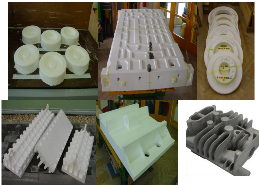
Gambar 4.15 Pola dari plastik dan sterofoam ( www.arcabrasives.com )
